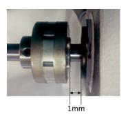
将电机转子前端面调整到与后套端面间距 1mm,后用 3mm 内六角扳手拧紧转子螺钉,转子有一颗螺钉要对准上轴平面。
