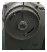
将手轮旋转方向的第一颗螺钉对准上轴平面,用 2.5mm 拧紧手轮的两颗螺钉,并确认手轮前端 未与罩壳碰擦。
