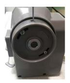
将手轮旋转方向的第一颗螺钉对准上轴平面,用 2.5mm 拧紧手轮的两颗螺钉,并确认手轮前端未与罩壳碰擦。
