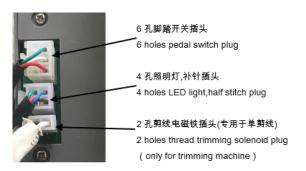
将各功能插头插到电控上,并确认连接可靠。
