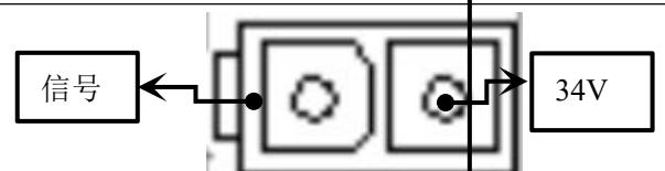
抬压脚电磁铁线端口
