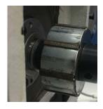
将电机转子前端面紧靠后套端面,后用 3mm 内六角扳手拧紧转子螺钉,转子有一颗螺钉要对准上轴平面。
