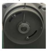
将手轮旋转方向的第一颗螺钉对准上轴平面,用 2.5mm 拧紧手轮的两颗螺钉,并确认手轮前端未与罩壳碰擦。
